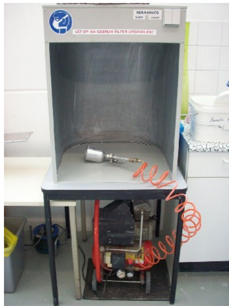
Spuitkabine met afzuiging, compressor en glazuurspuit:
